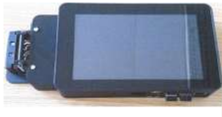
Prototyp eines transportablen Messgeräts zur Detektion magnetischer Nanopartikel in Schmierstoffen
