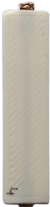
Abb. 2: In PLA integrierte elektrische Struktur (Bauteillänge 65 mm)
