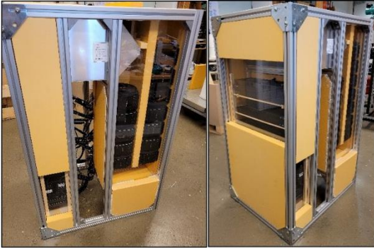
Abb.: Funktionsmuster der Abluftwärmepumpe
