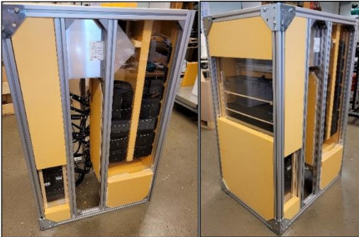
Abb.: Funktionsmuster der Abluftwärmepumpe
