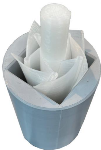
Abb. 3: Außengreifer beim Eingriff in ein quadratisches Loch
