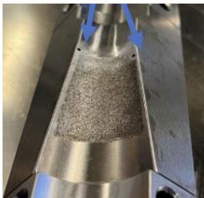
Aktivelement mit Austrittsöffnungen für die Minimalmengenschmierung
