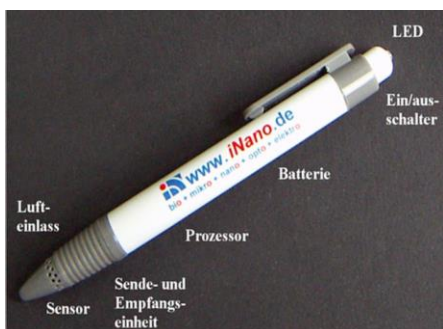
Abb. 2: Mobiler Betauungssensor für den Vororteinsatz im Kugelschreibergehäuse
