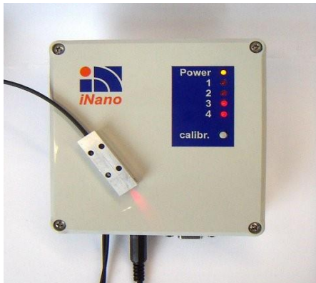
Abb. 1: Prototyp der FobT Sonde mit Mess- und Ableseeinheit
